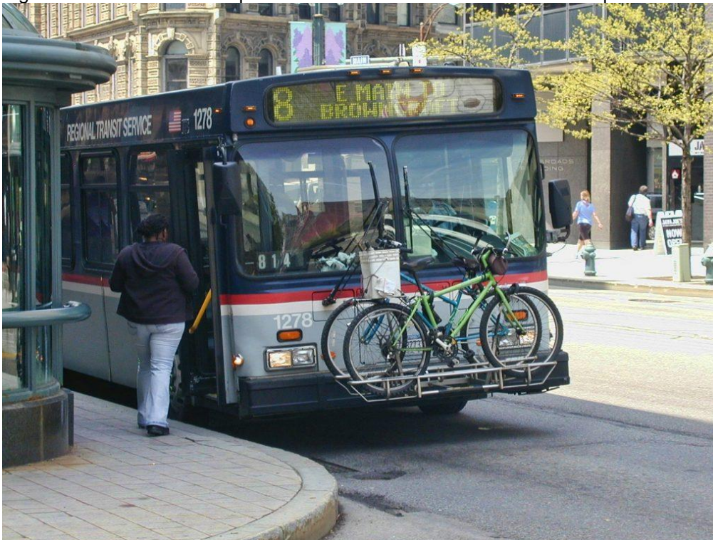
Figura 29 – Modelo de rack para bicicleta instalado em veículo de transporte coletivo em Nova Iorque
